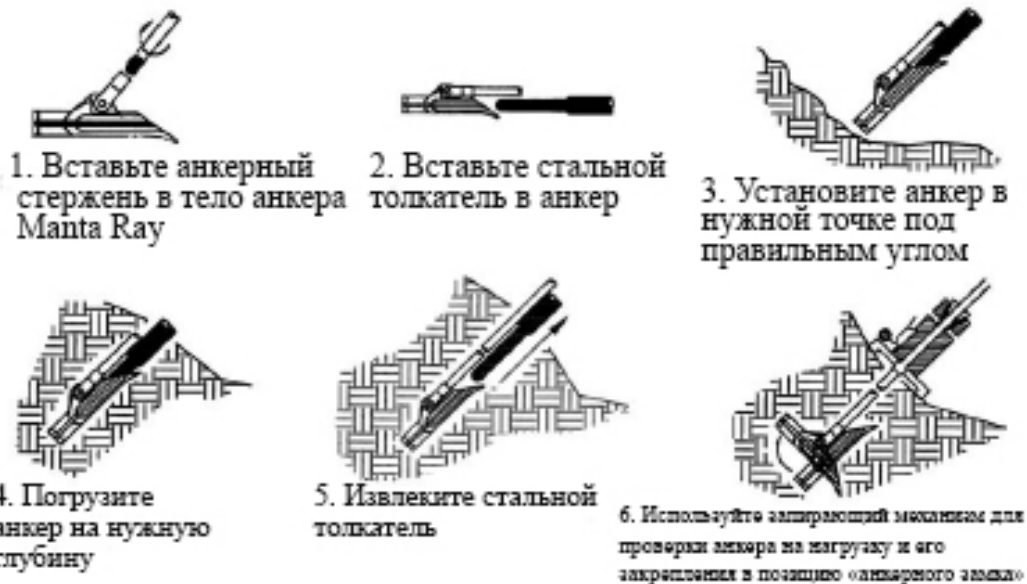
Рис. 2. Принцип действия
